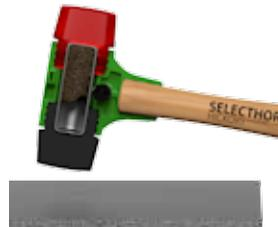
Die mikrofeinen Metallkugeln des Anti-Rückschlag-Inlays werden durch die Fliehkraft nach hinten bewegt.
