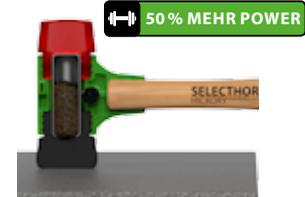
Jetzt stößt die gesamte Masse des Anti-Rückschlag-Inlays nach und erzeugt das 1,5-Fache an Schlagenergie. Gleichzeitig wird ein Zurückprallen des Selecthor verhindert.
